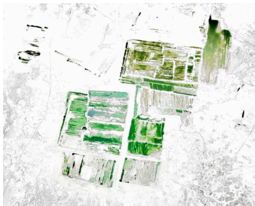
Imagen 14. Frente de trabajo inundado en el centro del Salar. La tonalidad verde azulada corresponde a la presencia de agua de la escorrentía superficial dentro de la trinchera 139 .
