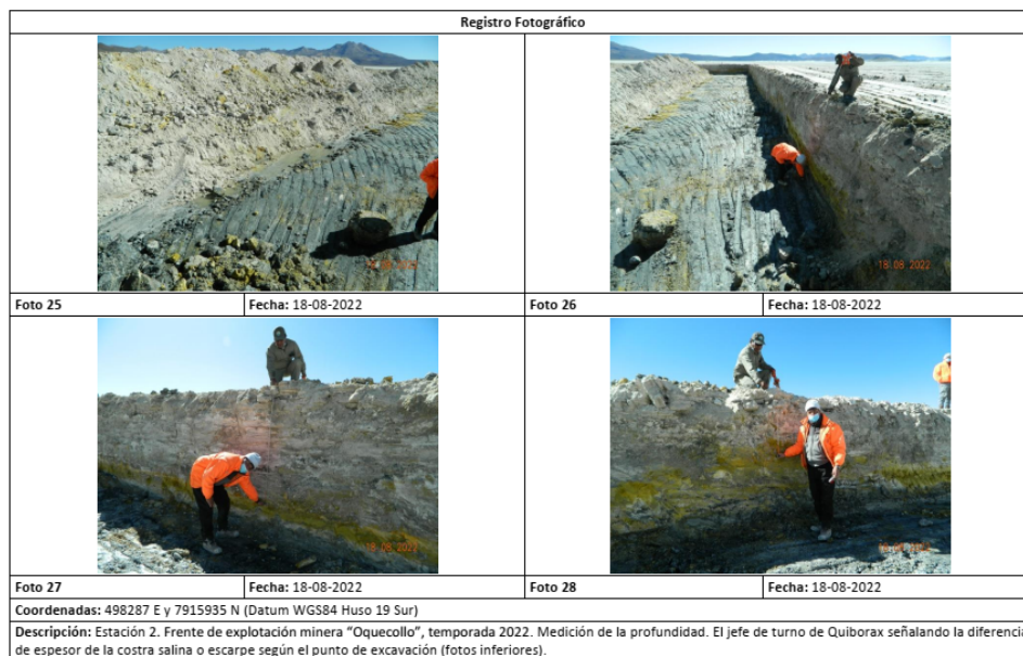
Imagen 11. Frente de trabajo del año 2022. Interior de trinchera sin rellenar con escarpe o sobrecarga, donde son visibles los efectos inmediatos del método de explotación sobre la capa superior de los depósitos salinos típicos del Salar 125 .
