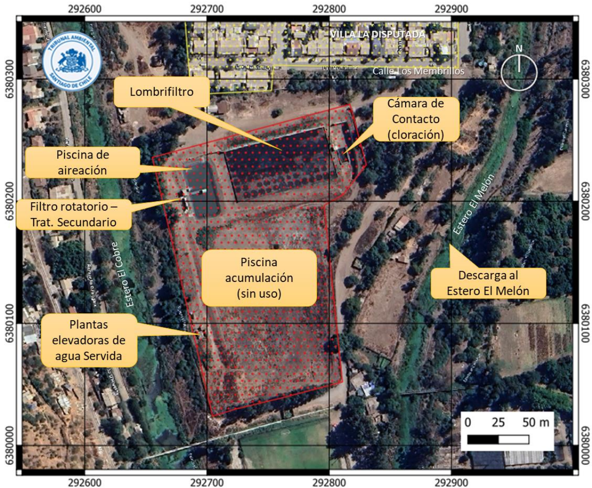
Figura N° 2: Cartografía de Detalle de Unidades Operacionales de la Planta de Tratamiento de Aguas Servidas El Melón
